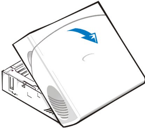
Abbildung 2. Die Slimline-Systemabdeckung entfernen
