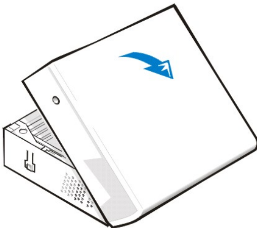
Abbildung 2. Die Slimline-Systemabdeckung entfernen
